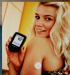
Auf dem Lesegerät steht der Zuckerwert. Die Tendenz, ob er steigt, sinkt oder gleichbleibend ist, zeigt ein kleiner Pfeil
